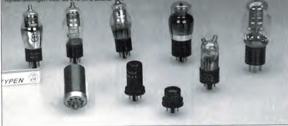
Figuur 6: alle typen voorkomend in de 19-set op een rijtje, zowel die voor de Tx als voor de Rx functies van de A-set en de B-set. Geheel rechts de beroemde 807 en direct links daarvan de UHF-buis CV6, met twee topaansluitingen voor de 240 MHz Lecher-lijn.
